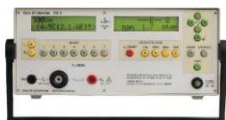
Abb.: Tera-Ohmmeter TO3
