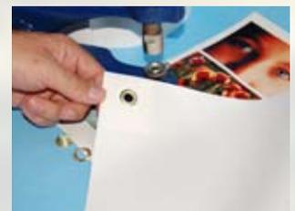
um ein Ausreißen der Ösen zu verhindern. Beim Aufrollen von verstärkten Bannern muß das Tape nach außen gewickelt werden. EASY-EDGE ist perfekt geeignet, um Banner mit Ösen zu versehen, dadurch wird eine hohe Reißfestigkeit erreicht. Die Ösen müssen im angemessenem Abstand eingesetzt werden.
