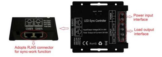
RGB Connection:  $V+\rightarrow COM$ ,  $CH1\rightarrow R$ ,  $CH2\rightarrow G$ ,  $CH3\rightarrow B$
