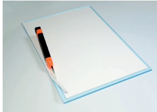
2. Lichtstreufolie ca. 5 mm umlaufend vom Rand abschneiden.
