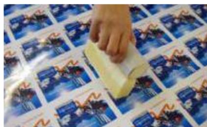
Flüssiglaminat zum Versiegeln von mit Solvent-, Light-Solvent und ECO-Solvent Tinten gedruckten Aufklebern (formgeschnittenen Aufklebern), das die Kratzfestigkeit und UV-Beständigkeit der Oberfläche verbessert.
