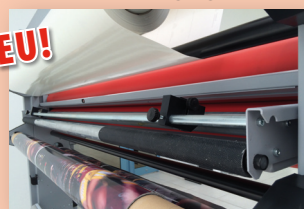
Längsschneideeinheit - kein zweiter Arbeitsgang notwendig
