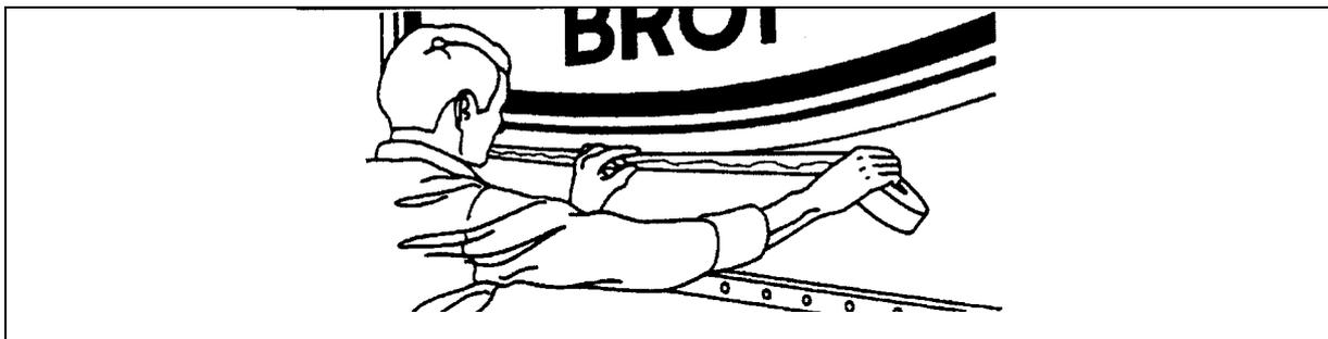
3. Bei einer Verarbeitungstemperatur (Objekt- und Umgebungstemperatur) von mind. +10°C (bei Temperaturen über +28°C bitte im Schatten arbeiten), das 3M Graphic Remover System mit dem Pinsel oder Heizkörperroller satt auf die Folienfläche aufstreichen.
