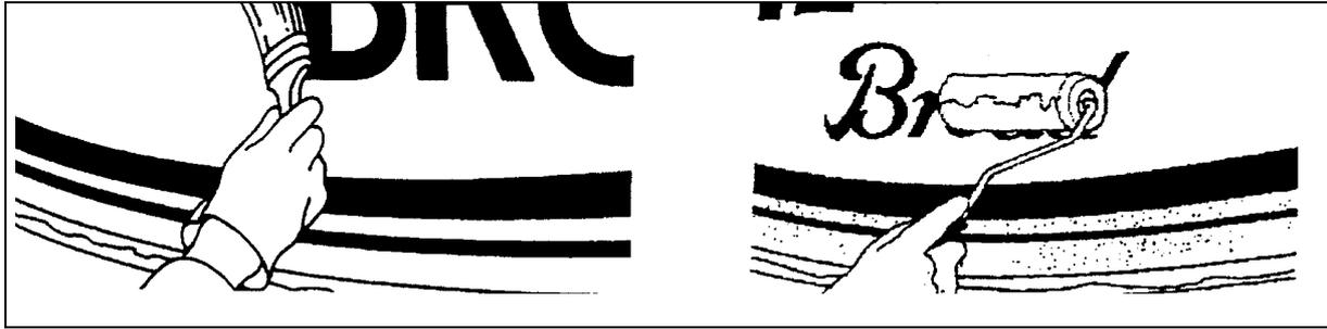
4. Das 3M Graphic Remover System mindestens 15 Minuten trocknen lassen. Der günstigste Trocknungs-grad ist abhängig von Raumtemperatur und relativer Luftfeuchte:
