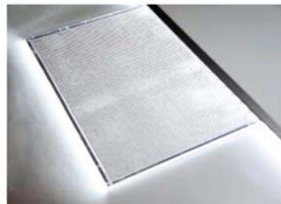
LED einleuchten und dunkle Flecken nachrakeln.
