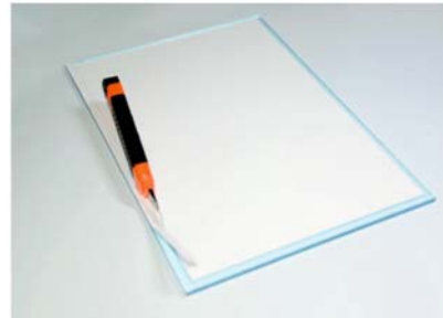
Lichtstrefolie ca. 5 mm umlaufend vom Rand zurückschneiden.
