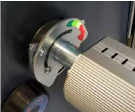
Die Achse vorn unten (Abrollachse R1) und die Achse hinten (Aufrollachse R2) werden mit einem Schließmechanismus gesichert, damit die Achse sicher in der Halterung verbleibt.
