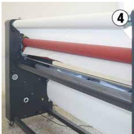
Positionieren Sie die Klinge des Easylam-Cutters zwischen Folie und Abdeckpapier
