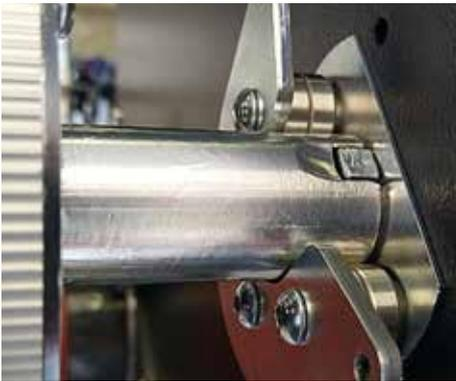
Dabei wird der Antriebsbolzen in die Führung der Achse gesteckt.
