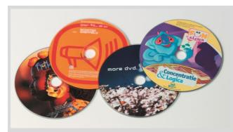
Der wasserlose Offsetdruck ist im OD-Bereich fest etabliert, da er mit seiner hohen Rasterauflösung und Punktschärfe die Dekoration aller gängigen Formate in unübertroffener Fotoqualität ermöglicht.
